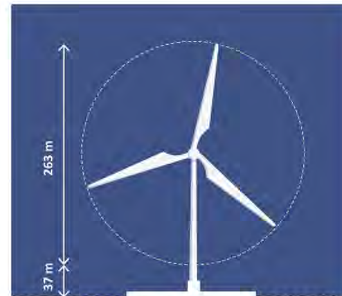
Figur 11. Ett exempelverk med rotordiameter på 263 meter och en totalhöjd om 300 meter. Ansökan för Skagerrak Offshore Gamma avser vindkraftverk om 370 meter maximal totalhöjd.
