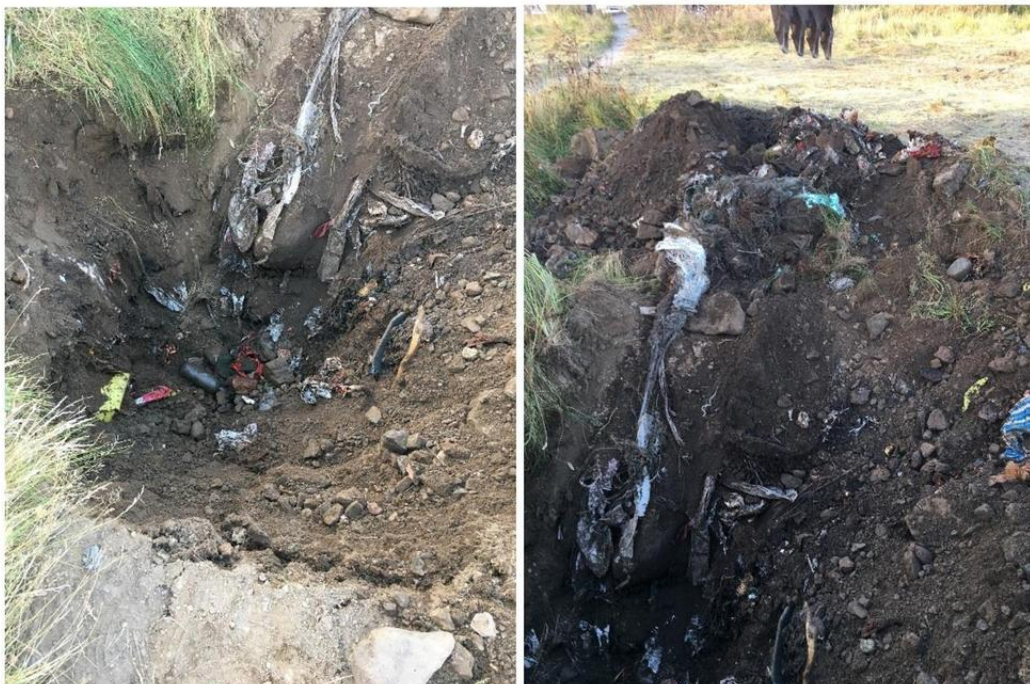
Figur 5: Fyllmasser (jord/sand og avfall) ved Steinrevet 20.
