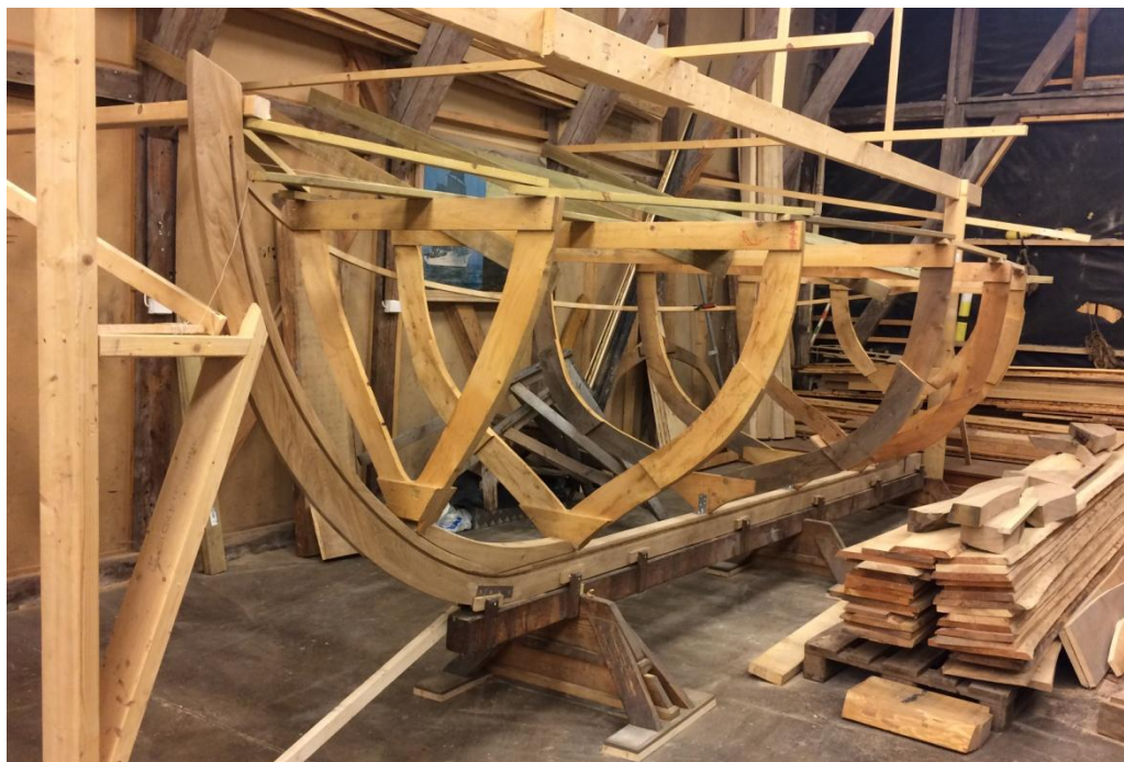
Nybygging av sjeke i Skur 13, Fredriksvern verft. Tore Johansen 2016
